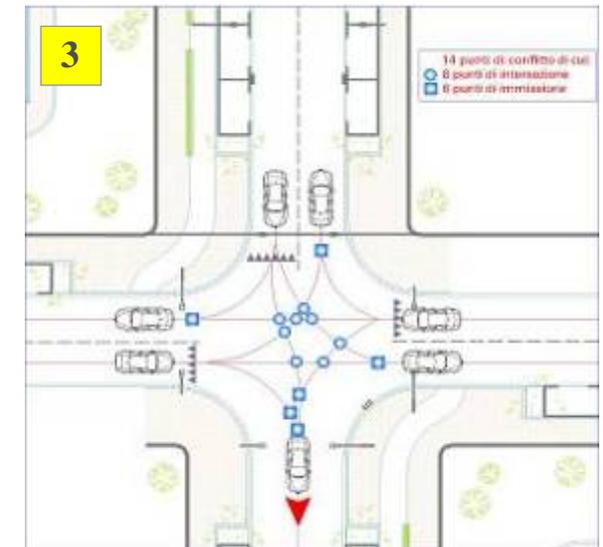
Inserendo il **SENSO UNICO SU UNA SOLA STRADA** delle quattro che compongono in incrocio tipo, si riducono a 17 i conflitti (-39%) se il senso unico è in ingresso (esempio 2), e a 14 conflitti (-50%) se è in uscita (esempio 3).
