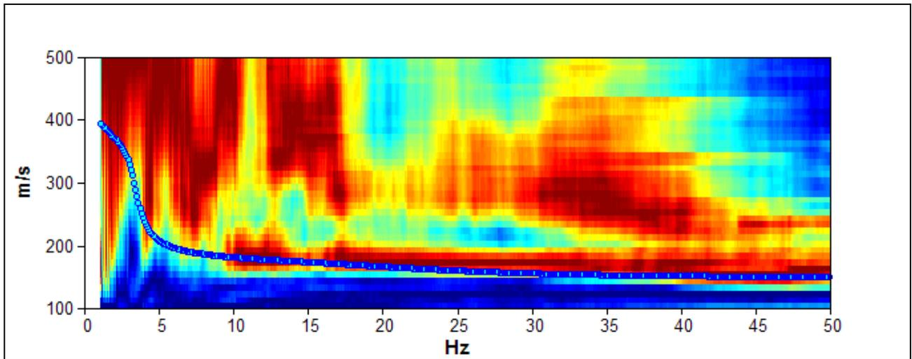
Dalla prova ReMi si vedono orizzonti ad alte velocità che corrispondono ai moti superiori, ed un orizzonte a velocità più basse, che rappresenta la velocità reale delle onde S nel terreno.
