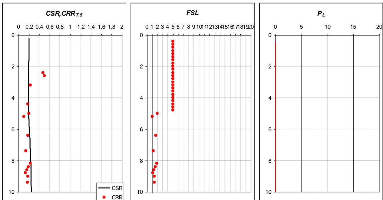
Come è evidente gli strati che presentano un fattore di sicurezza inferiore a 1 sono assenti, il che si traduce in un valore di  $P_L$  pari a 0 ad indicare come il rischio di liquefazione sia praticamente nullo.
