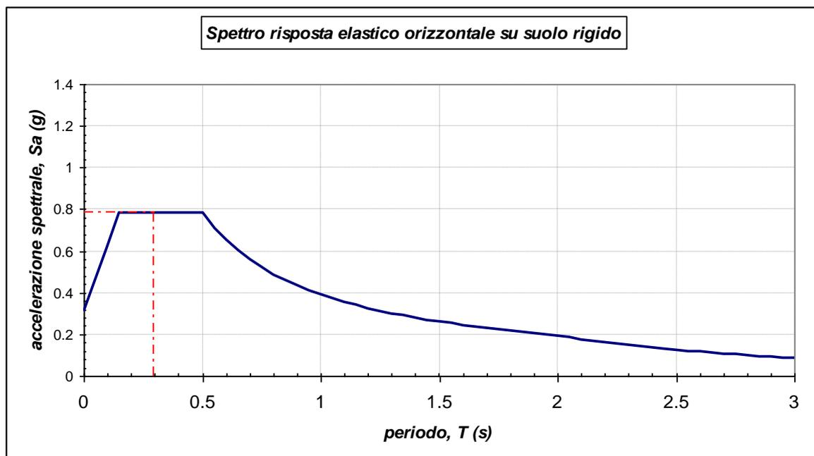
Lo spettro di risposta elastico individua le accelerazioni indotte da un sisma sull'edificio (inteso a bassa duttilità), il cui comportamento è assimilato ad un oscillatore elastico smorzato.
