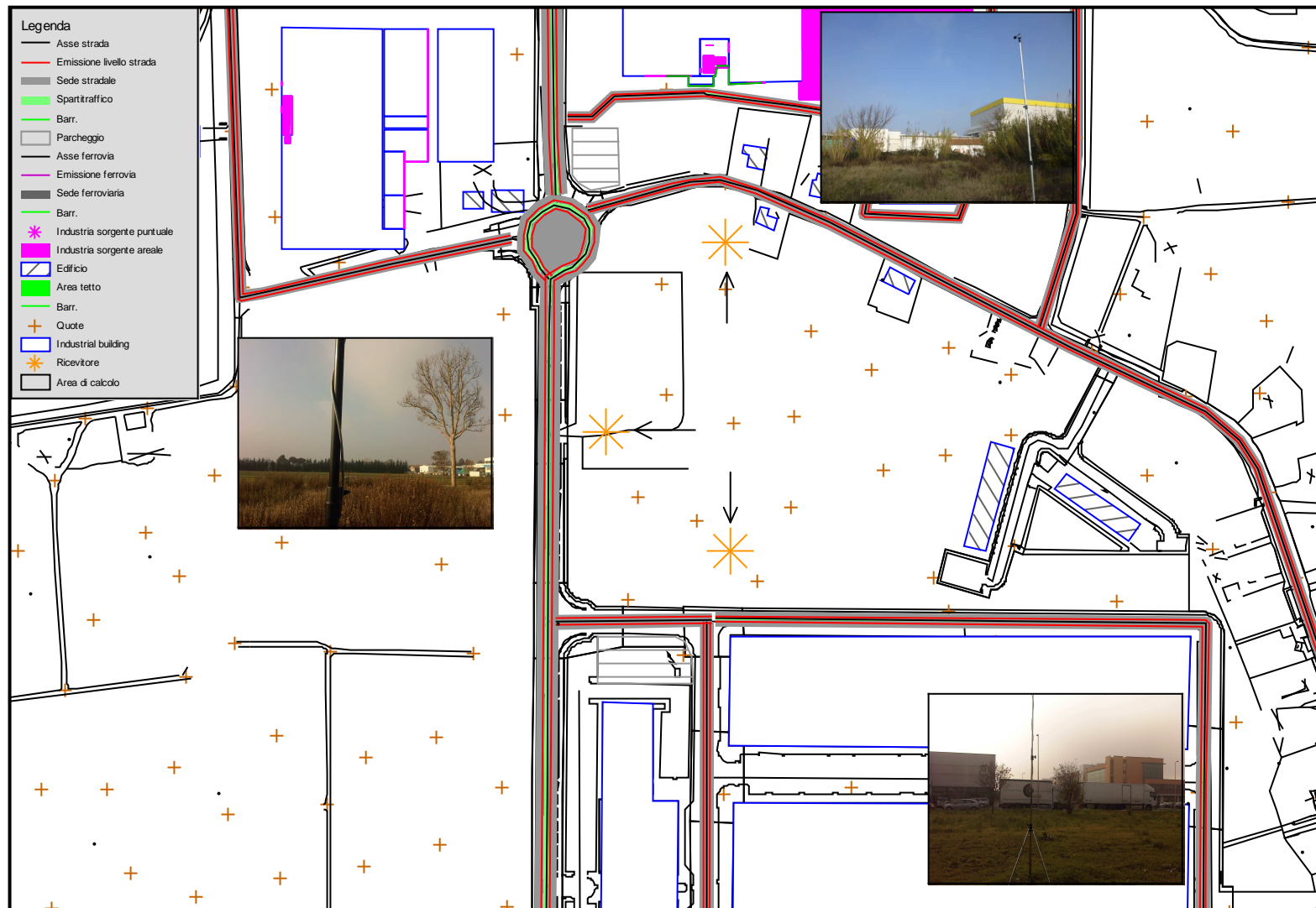
Planimetria indicante i punti di misura eseguiti nei pressi delle sorgenti principali. (foto con viste dal punto di misura verso le sorgenti)
