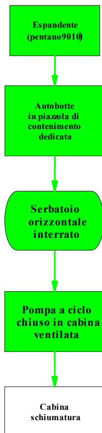
Fig. 5 – Schema a blocchi rifornimento e adduzione espandente (pentano 9010)
