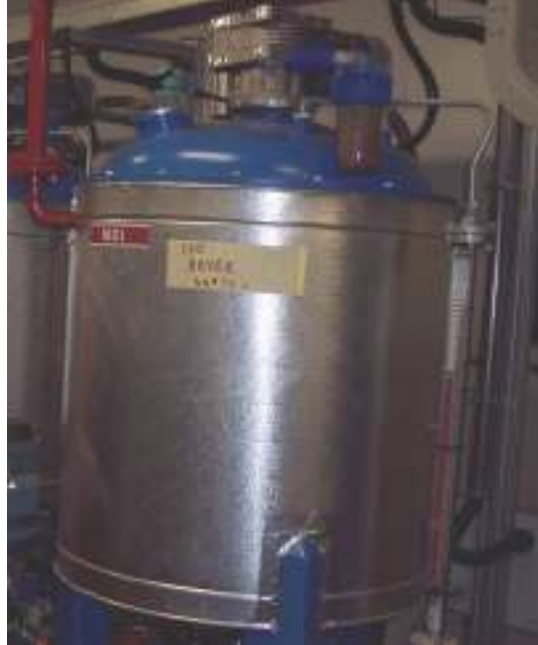
Foto 5 – Serbatoio intermedio del polimetilen polifenil isocianato
