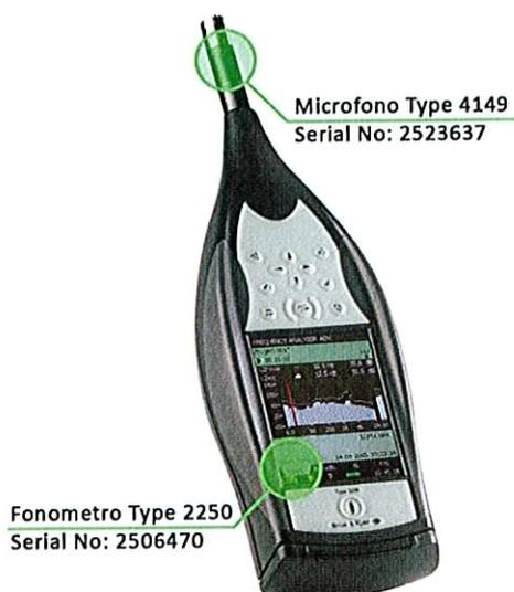
Strumentazione utilizzata per il rilievo del punto P2.
