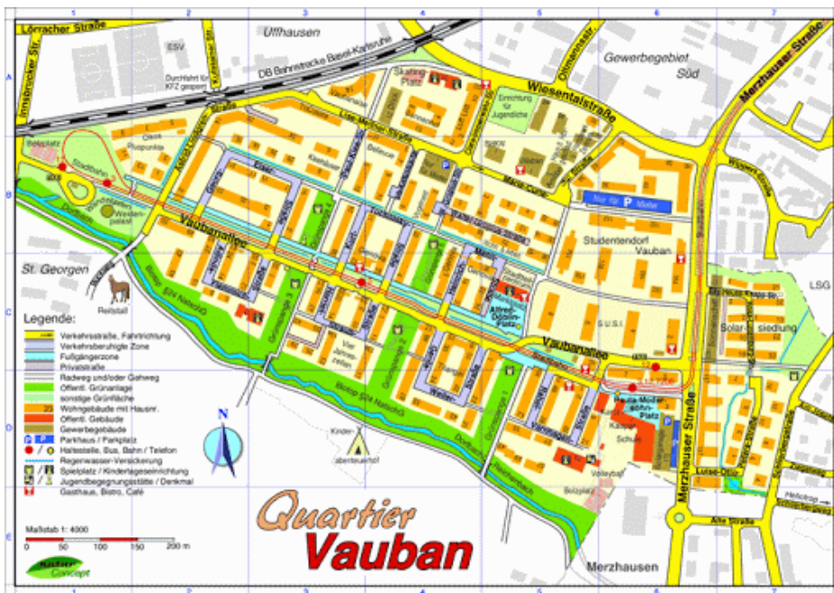
Planimetria quartiere Vauban, Friburgo. Si notino, in giallo , le strade carrabili principali, in grigio quelle pedonali (a lentissima percorrenza carrabile) e i parcheggi posizionati ai margini del quartiere.
