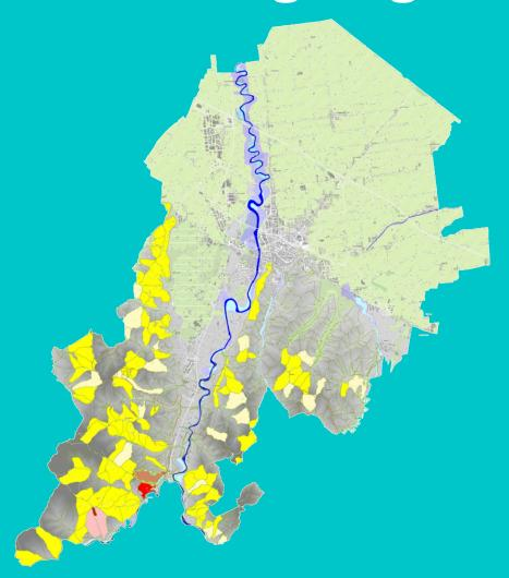
Area a rischio idraulico Art. 2ter PAI-Alveo Art. 3 PAI-Aree ad elevata probabilità di esondazione Art. 4 PAI-Aree a moderata probabilità di esondazione Art. 6 PAI-Aree di potenziale allagamentto Fonte: A.d.B. Fiumi Romagnoli
